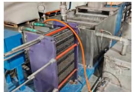
2.公司采用了节省或回收水资源的冷却系统，例如采用水冷工业制冷机、冷却水塔等组成的冷却系统。该系统采用 33.7kw 压缩机，水箱容量 100L，可实现低温冷冻水与生产线造粒冷却水进行热交换，热交换后的水回流至冷冻机水箱重新降温，整个流程为全封闭状态。
